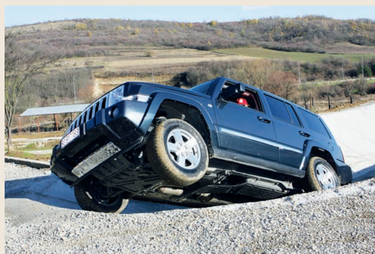
Kada zapreti mogućnost da se prevrnete, okrenite točkove naniže
