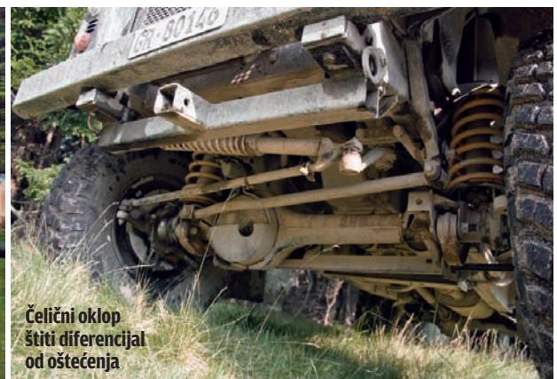
Čelični oklop štiti diferencijal od oštećenja
