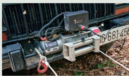
Upotrebom koturače duplirate efektivnu snagu vitla, a možete je koristiti i za uklanjanje prepreka
